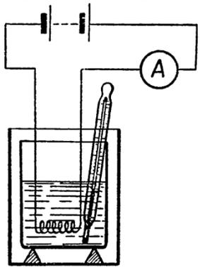
На столе собрана установка. Сопротивление спирали 4 Ом. В пробирке 20 г воды. Подсчитать (без учета потерь тепла), через сколько времени должна закипеть вода, если сила тока в цепи будет 2 А. Измерить температуру воды и замкнуть цепь. Определить на опыте время нагревания воды до кипения. Объяснить расхождение результата, вычисленного и полученного на опыте.
