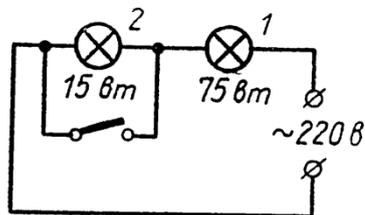
Как установить на опыте, которая из двух одинаковых по внешнему виду ламп, рассчитанных на 220 в каждая, имеет большую мощность, если надписи на лампах стерлись.
