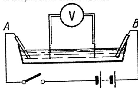
Измерить напряжениена клеммах источника тока напряжением 10 — 12 в, имея два вольтметра с пределами измерения до 6 в.
