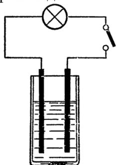
К одной клемме миллиамперметра на 5 мА присоединить через провод железный гвоздь, к другой — медный стержень. Проверить на опыте, как будет изменяться сила тока, если гвоздь и стержень медленно погружать в раствор поваренной соли, и какой электрод будет заряжен отрицательно.
